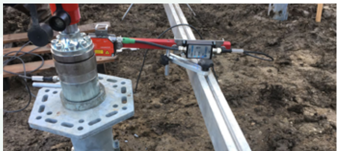
Controle van druk beproeving, middels precisie laser meet instrument, zie op deze afbeelding ook de speciale 245 mm flenskop.
